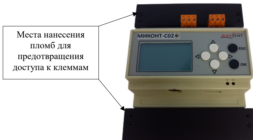
Рисунок 4 – Пломбировка клеммных соединений модификаций Миконт-С02, Миконт-С03, Миконт-С04, Миконт-331
