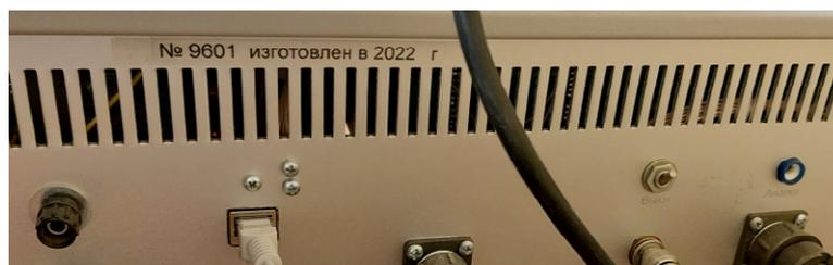
Рисунок 2 – Маркировочная табличка на задней стенке корпуса ПУ
