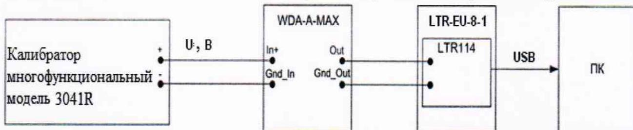
Рисунок 1 – Схема поверки ИК напряжения постоянного тока с помощью РЭТ (калибратор многофункциональный модели 3041R)
