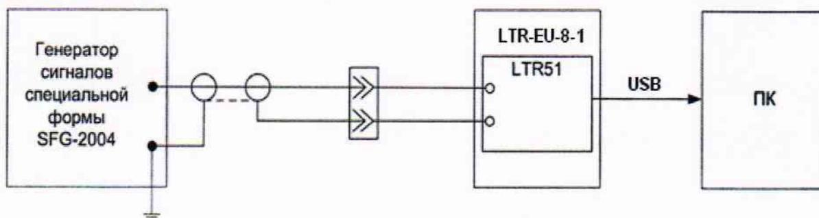
Рисунок 3 – Схема поверки ИК частоты электрических сигналов переменного тока с помощью РЭТ (SFG-2004)
