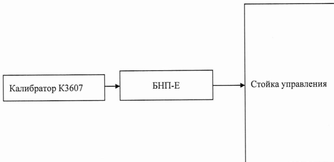
Рисунок 1 - Функциональная схема для проверки МХ ИК силы и напряжения разбаланса тензомоста.
