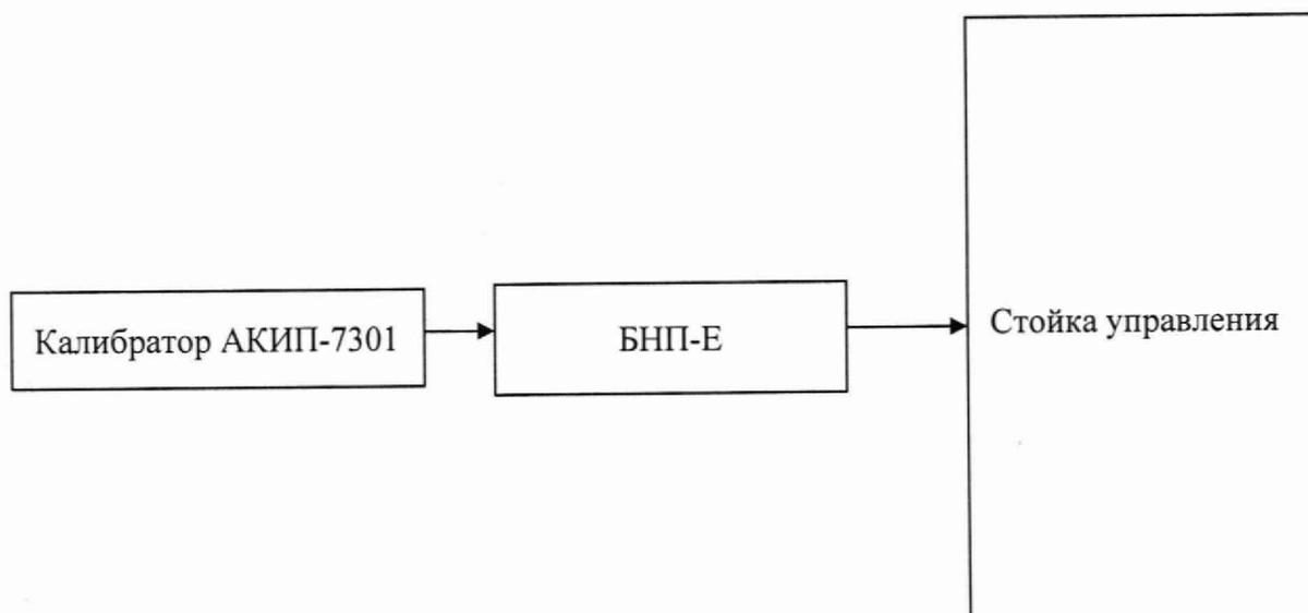
Рисунок 2 - Функциональная схема для проверки МХ ИК угла
