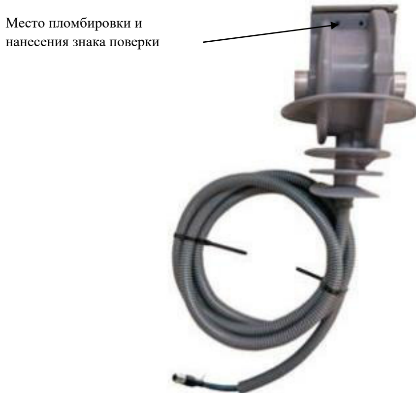
Рисунок 1 – Общий вид средства измерений с указанием места пломбировки от несанкционированного доступа и нанесения знака поверки
