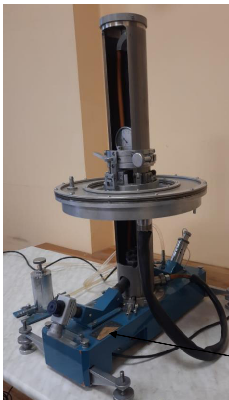
Рисунок 1 – Общий вид микроманометра ПМКМ-1
