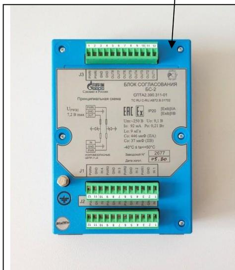
Рис 1г. Общий вид блока согласования БС-2
