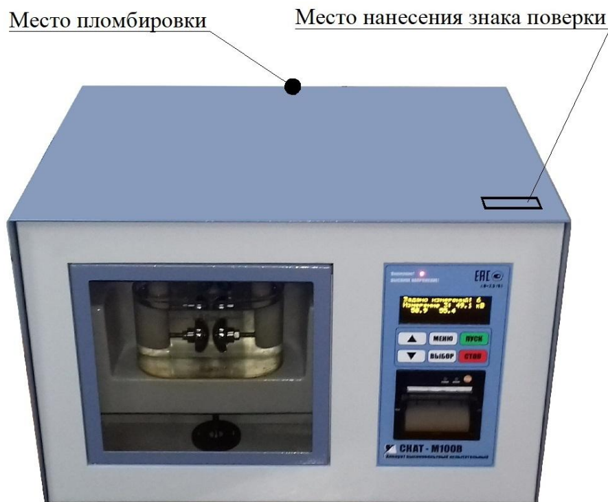
Рисунок 1 - Общий вид аппаратов высоковольтных испытательных СКАТ-М100В
