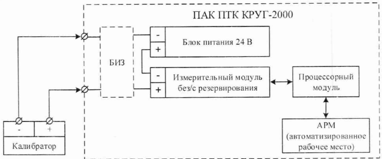
Рисунок А.2 – Функциональная схема при проверке каналов измерений силы постоянного тока для подключения к токовым датчикам (пассивным)
