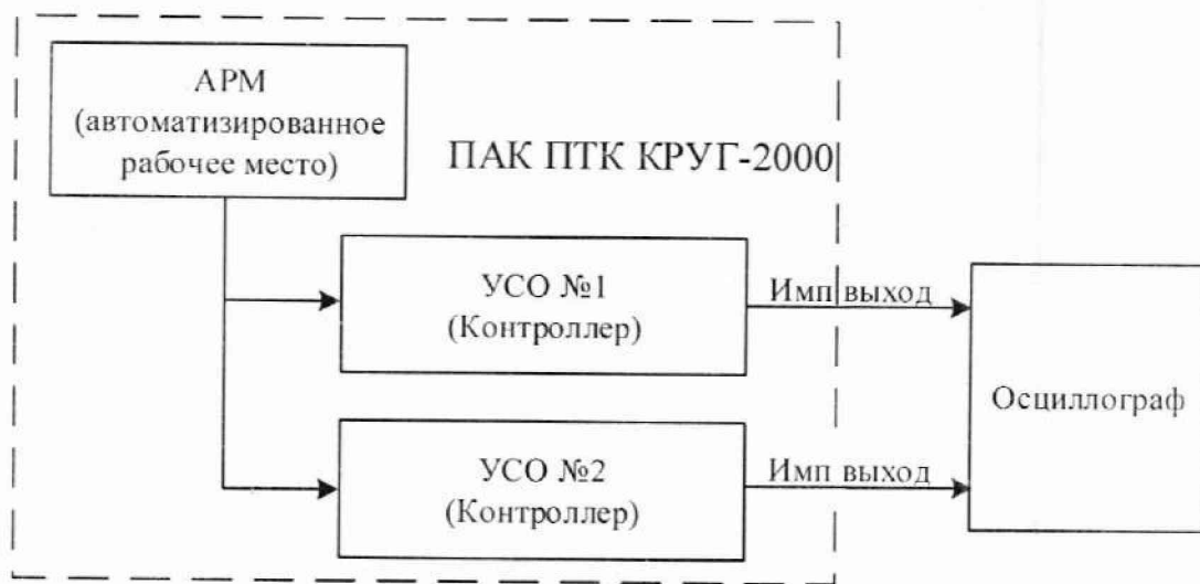
Рисунок А.8 – Функциональная схема при проверке каналов времени расхождения показаний между всеми абонентами ПАК ПТК КРУГ-2000
