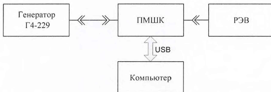
Рисунок 6 - Схема для определения модуля эффективного коэффициента отражения выхода преобразователя ПМШК
