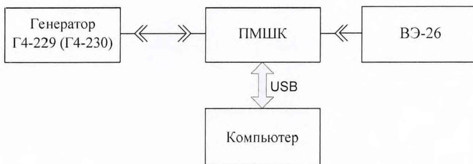
Рисунок 9 – Схема определения калибровочного коэффициента преобразователя ПМШК
