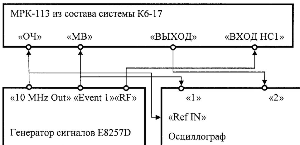
Рисунок 1 – Схема для определения инструментальной погрешности
