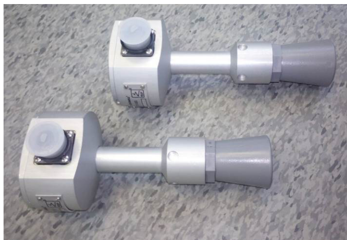
Рисунок 6 – Общий вид газоанализаторов серии Кедр ГА
