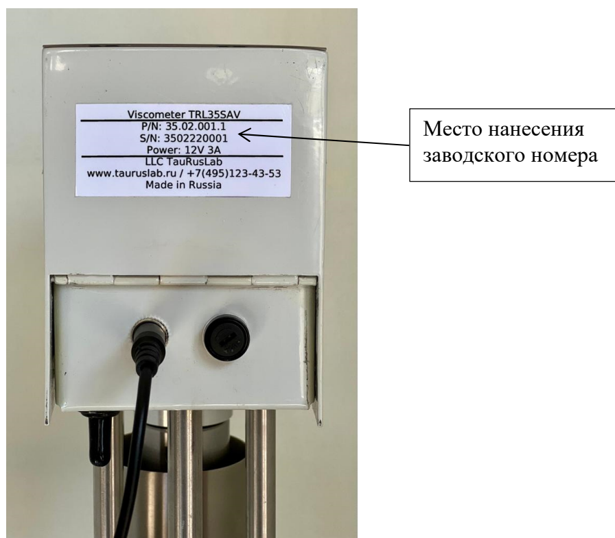
Рисунок 5 – Место нанесения заводского номера на вискозиметр TRL35SAV
