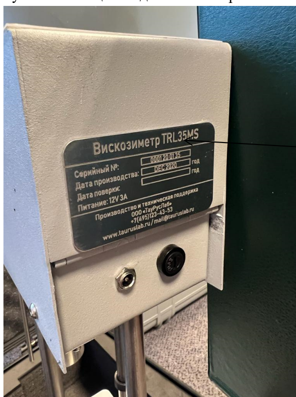
Рисунок 4 – Место нанесения заводского номера на вискозиметр TRL35MS
