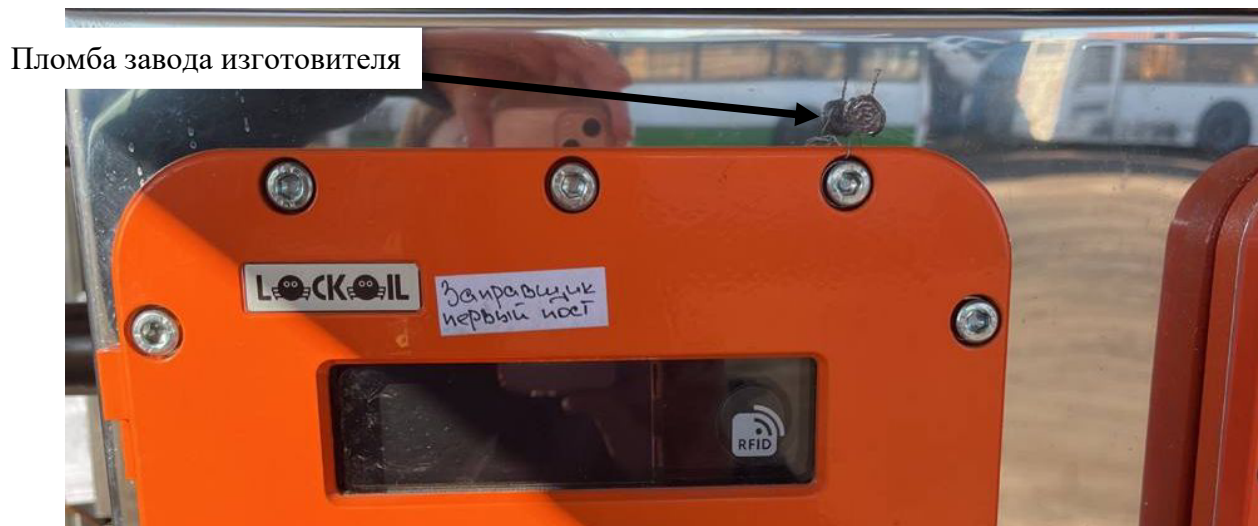
Рисунок 4 – Место установки пломбы завода изготовителя на корпусе блока управления
