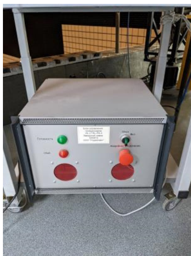
Рисунок 4 - Внешний вид блока управления позиционером RL-CTRL-PS-3
