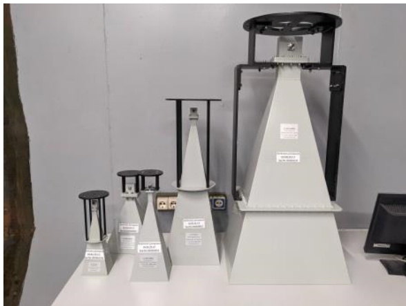
Рисунок 5 - Внешний вид комплекта эталонных антенн
