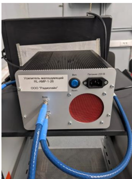
Рисунок 9 - Внешний вид усилителя малошумящего RL-AMP-1-26
