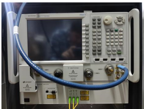
Рисунок 7 – Лицевая панель ВАЦ N5222В
