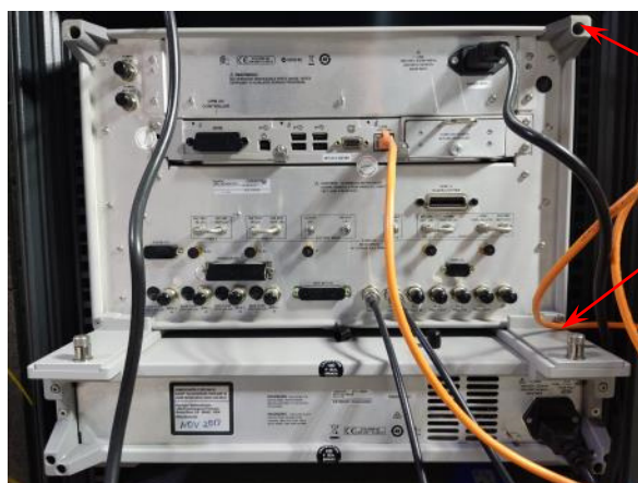
Рисунок 8 - Задняя панель ВАЦ N5222В (место пломбировки)
