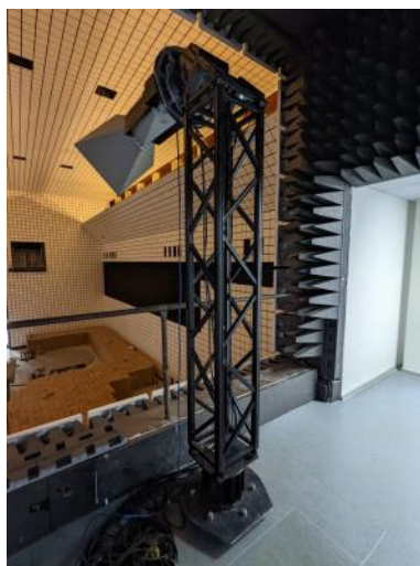
Рисунок 3 - Внешний вид прецизионного трехкоординатного позиционера РЛТГ.425820.214
