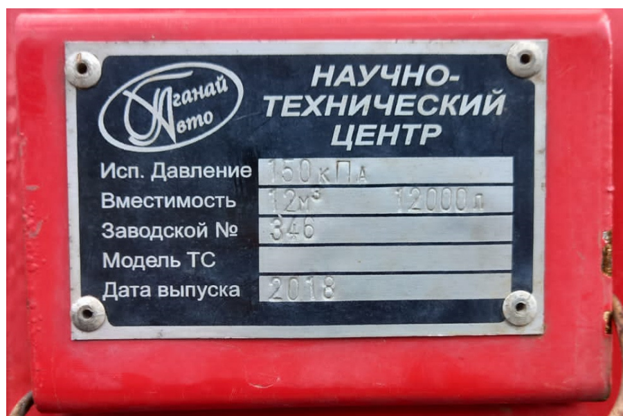
Рисунок 2 – Металлическая табличка с заводским номером автотопливозаправщика АТЗ-12
