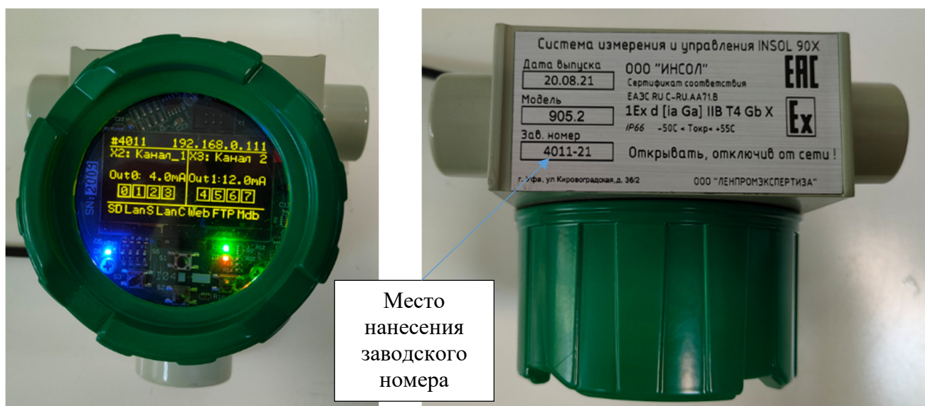
Рисунок 2 - Общий вид модуля расширения INSOL (модификация модуль ввода/вывода Insol – 905.2) с указанием места нанесения заводского номера
