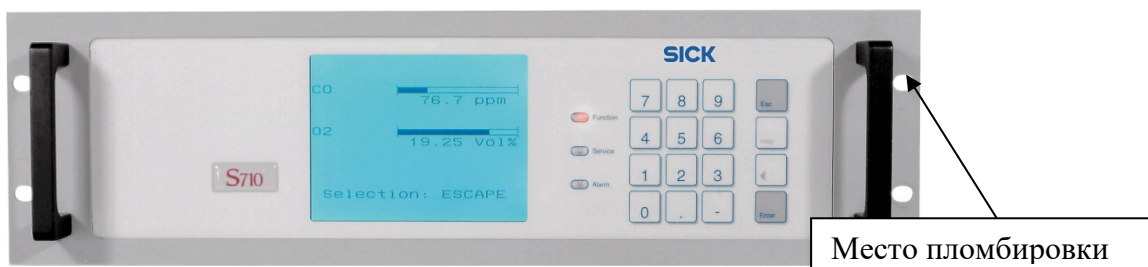
Рисунок 1 - Внешний вид газоанализаторов модульных S710, места пломбирования от несанкционированного доступа
