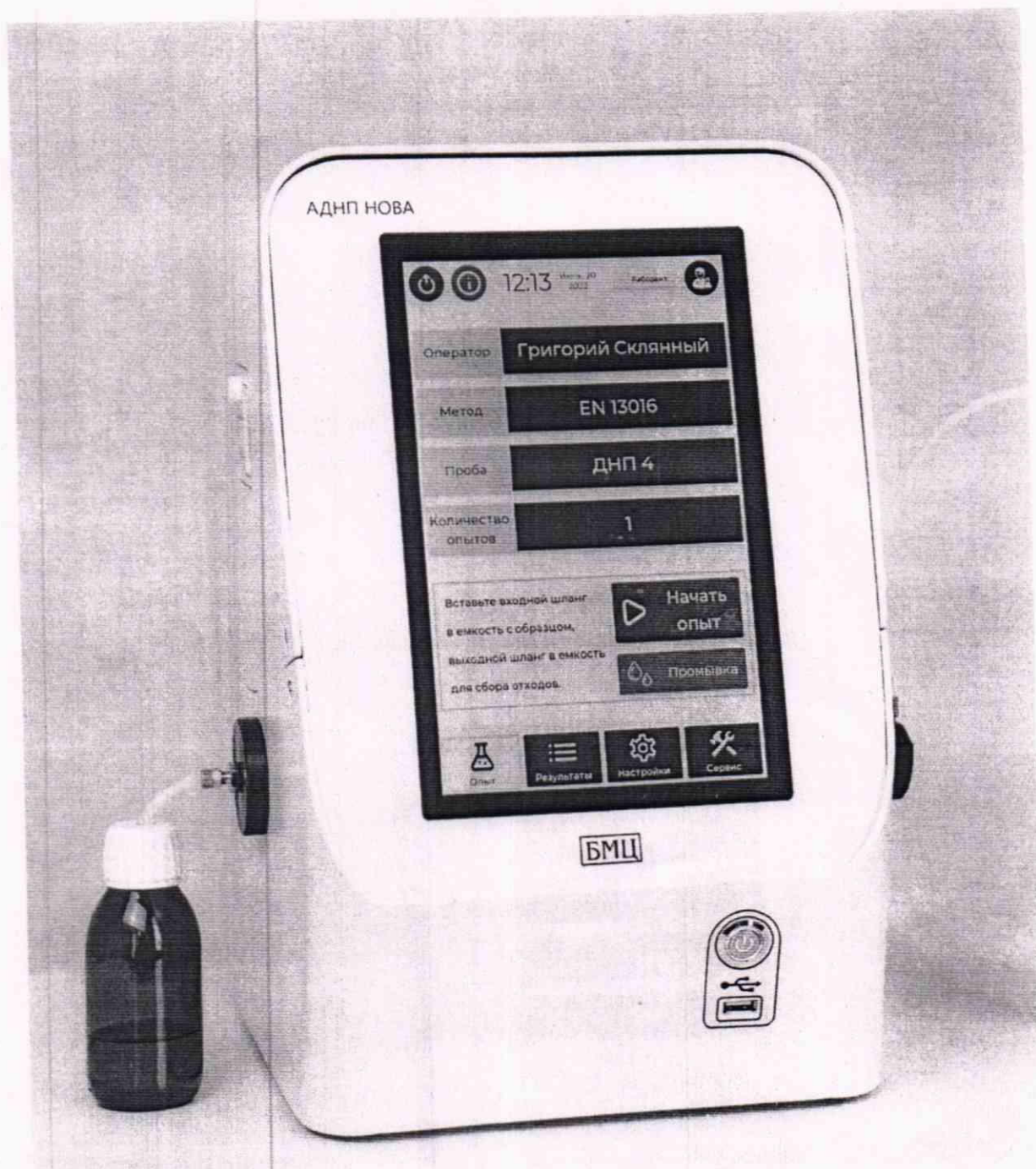
Рисунок 1.1 - Фотография общего вида анализатора давления насыщенных воздухом паров жидких нефтепродуктов «АДНП НОВА»
