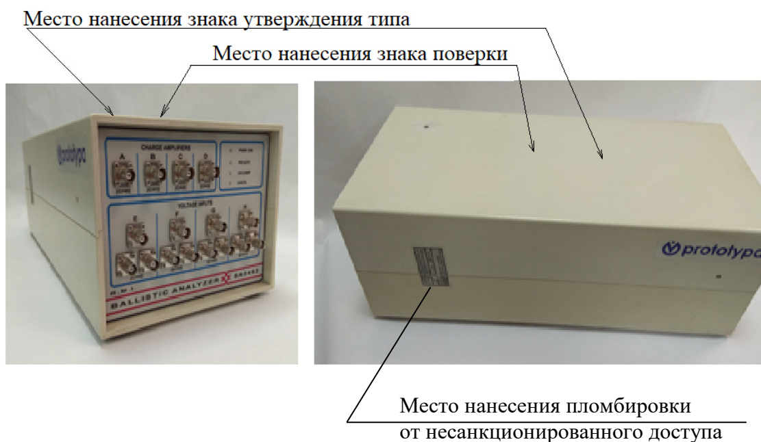
Рисунок 1 - Общий вид блока анализатора баллистического ВА04S, схема пломбировки от несанкционированного доступа, обозначение мест нанесения знака поверки и знака утверждения типа
