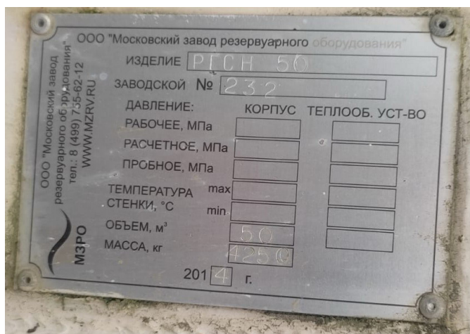
Рисунок 3 – Общий вид маркировочной таблички резервуара
