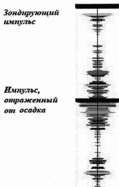
Рисунок Г.1- Пример эхограммы сигнала в емкости на месте эксплуатации (отражатель- поверхность осадка)
