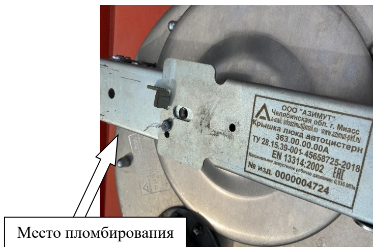
Рисунок 3 – Запорный механизм крышки заливной горловины и кран сливной для слива из отстойника
