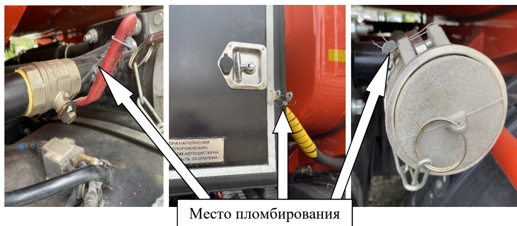
Рисунок 4 – Заглушка быстроразъёмного соединения, кран шаровый на трубопроводе, замок отсека узла выдачи топлива
