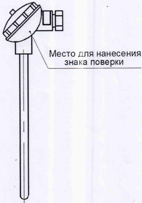
Рисунок 2.1 – Схема (рисунок) с указанием места для нанесения знака поверки средств измерений на ТС с клеммной головкой
