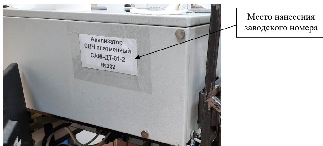
Рисунок 2 - Место нанесения заводского номера на анализаторы СВЧ плазменные САМ-ДТ-01-2
