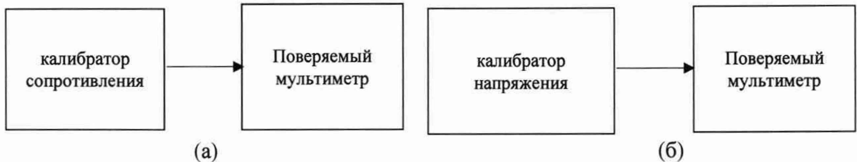
Рисунок 7 - Схема соединения приборов при проверке мультиметра в режиме измерений температуры: а) в режиме измерений сигналов термопреобразователей сопротивления, б) в режиме измерений сигналов термоэлектрических преобразователей
