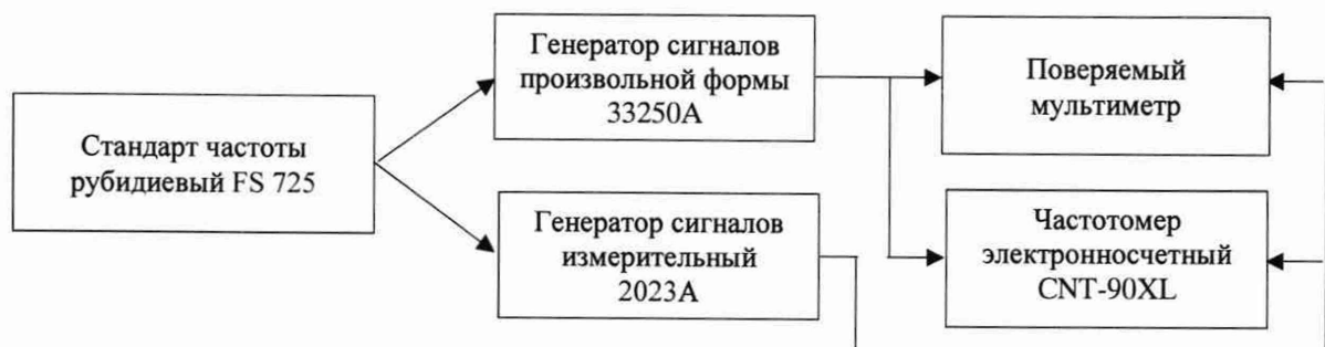
Рисунок 8 - Схема соединения приборов при поверке мультиметра в режиме измерений частоты
