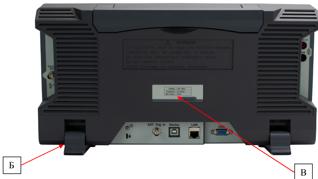
Рисунок 2 – Схема пломбировки от несанкционированного доступа (Б) и место нанесения серийного номера (В)
