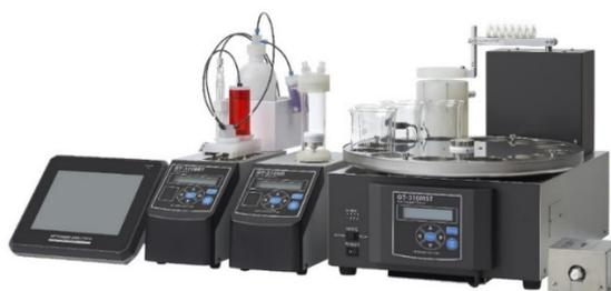
Рисунок 4 – Общий вид титратора GT-310 в комплектации: блок титрования GT-310MST (встроенный автоподатчик проб), мультиконтроллер СА-310МС, бюретка GT-310BRT и дозатор GT-310SD
