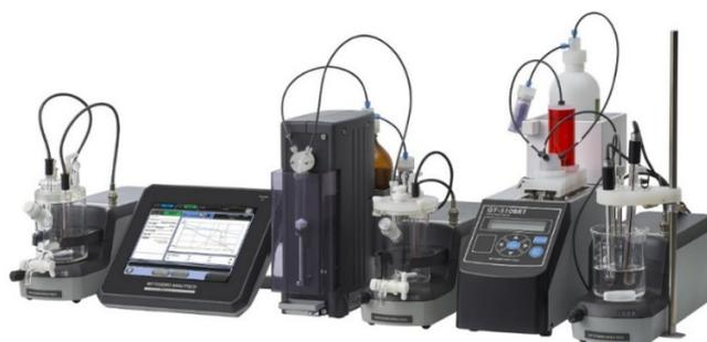
Рисунок 5 – Общий вид титратора GT-310, предназначенного для одновременного потенциометрического титрования (единичная проба), волюмометрического титрования по Карлу Фишеру и кулонометрического титрования по Карлу Фишеру в комплектации: мультиконтроллер СА-310МС, блок потенциометрического титрования GT-310STR, бюретка GT-310BRT, два блока титрования по Карлу Фишеру СА-310STR и бюретка СА-310BRT
