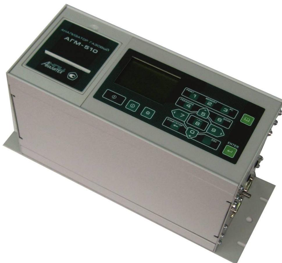
Рисунок 3 - Внешний вид газоанализаторов АГМ-510 -01.
