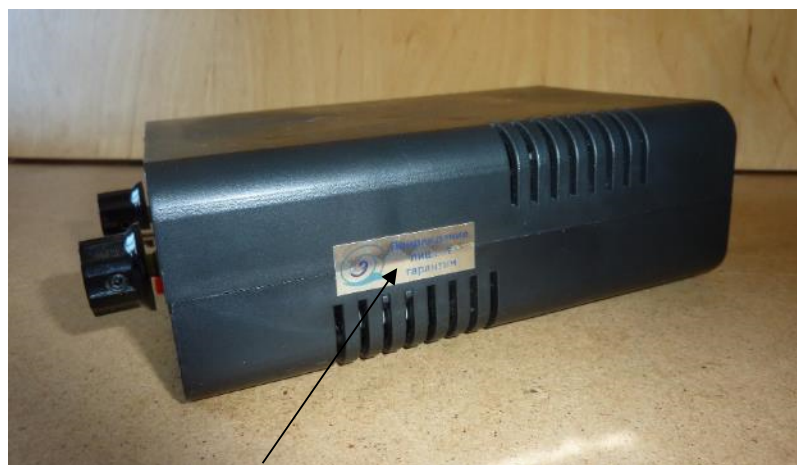
Рисунок 2 – Внешний вид ЛВОПП (вид сбоку) и место его пломбирования от несанкционированного доступа
