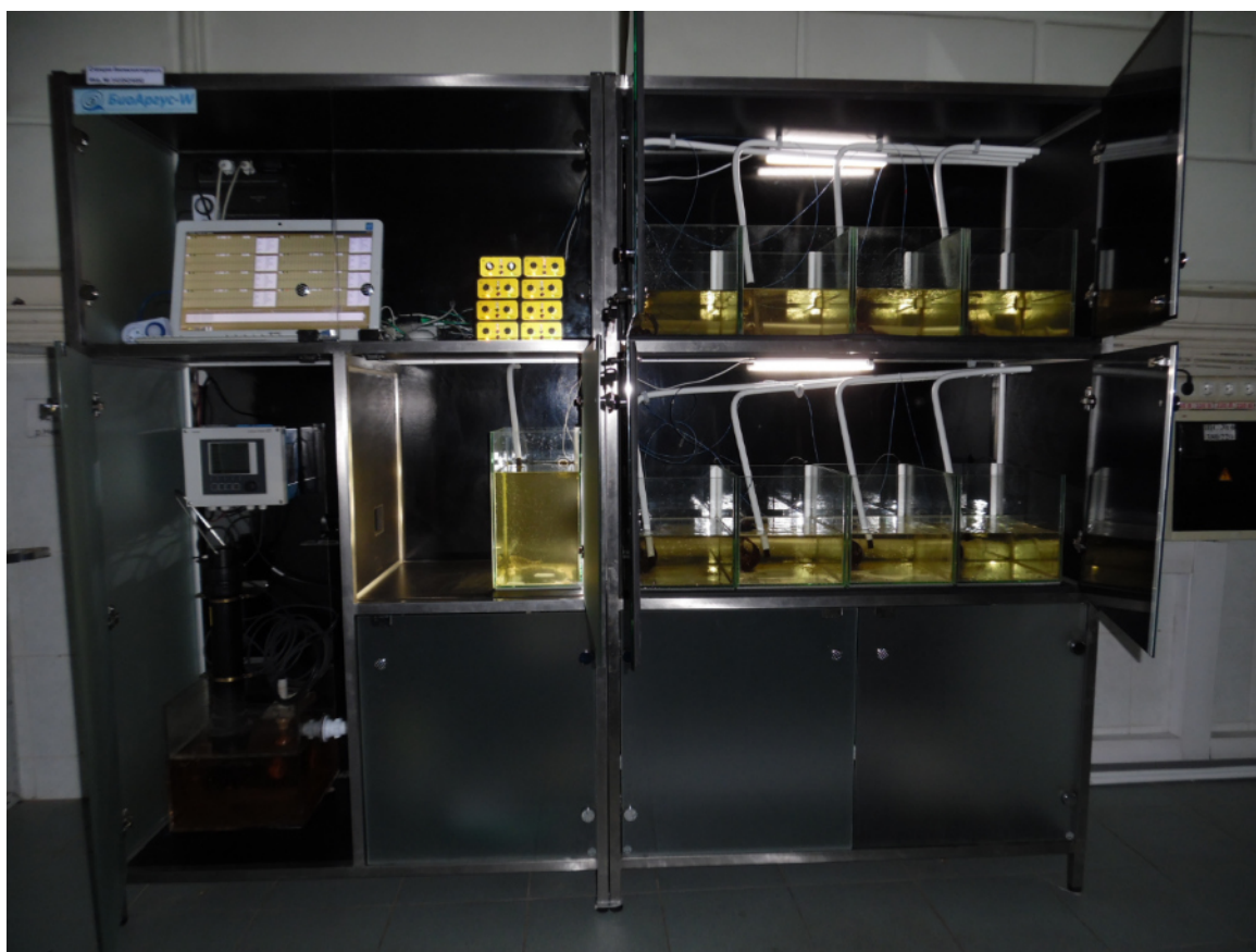
Рисунок 1 – Общий вид системы БиоАргус, смонтированной на месте эксплуатации в составе станции контроля качества воды водозабора (дверцы блока аквариумов открыты)
