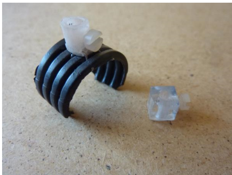
Рисунок 9 – Внешний вид держателя ВОЗ (два варианта)
