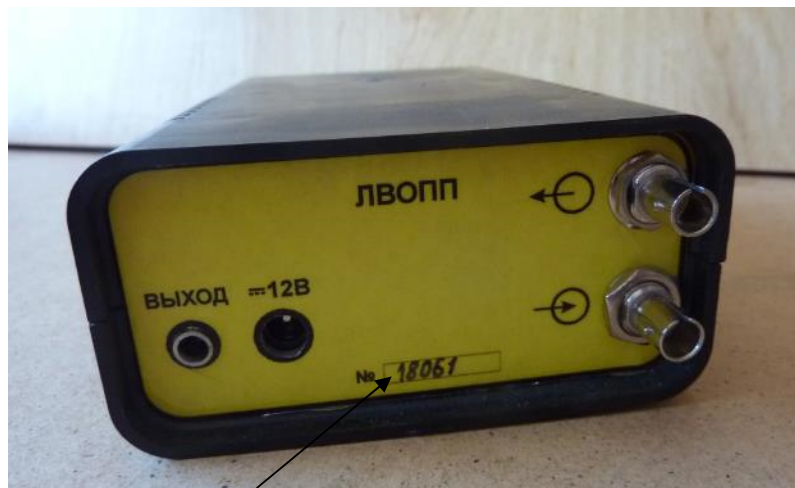
Рисунок 3 – Внешний вид ЛВОПП (вид сзади) и место нанесения его заводского номера
