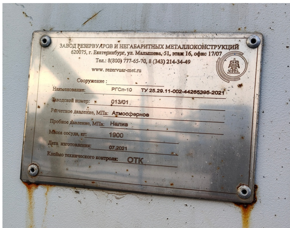
Рисунок 2 – Внешний вид металлической таблички с нанесенным на нее заводским номером
