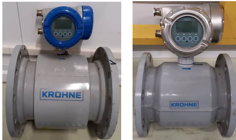
Рисунок 1 – Общий вид расходомеров-счетчиков электромагнитных OPTIFLUX 4300C
