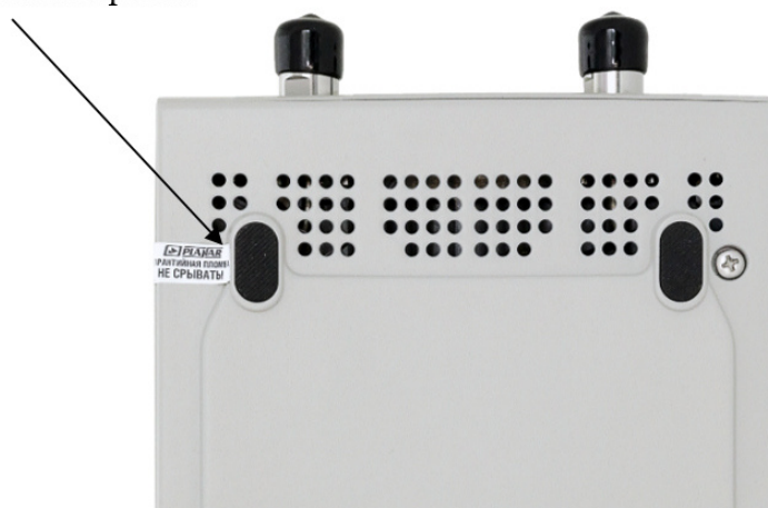
Рисунок 3 – Схема пломбировки от несанкционированного доступа
