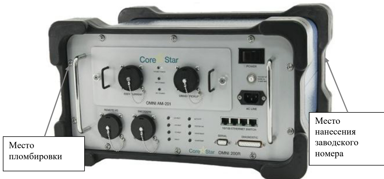
Рисунок 1 – Общий вид, схема пломбировки и обозначение места нанесения заводского номера дефектоскопов вихретоковых OMNI-200R
