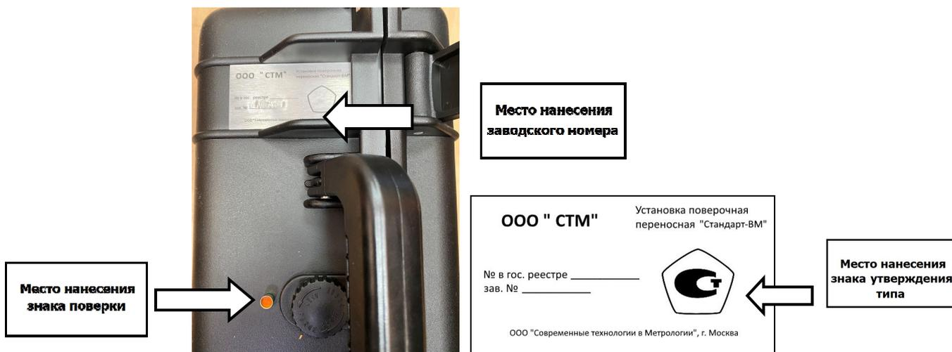
Рисунок 2 – Общий вид средства измерений с указанием мест нанесения знака утверждения типа, знака поверки, заводского номера
