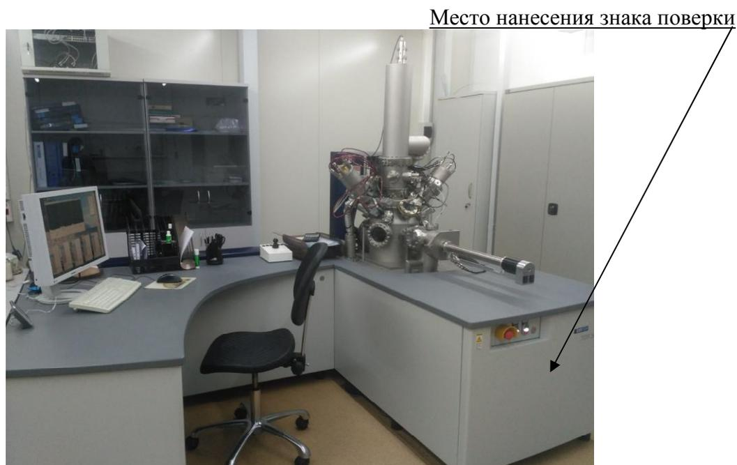
Рисунок 1 – Внешний вид масс-спектрометра времяпролетного вторично-ионного ToF.SIMS 5-100
