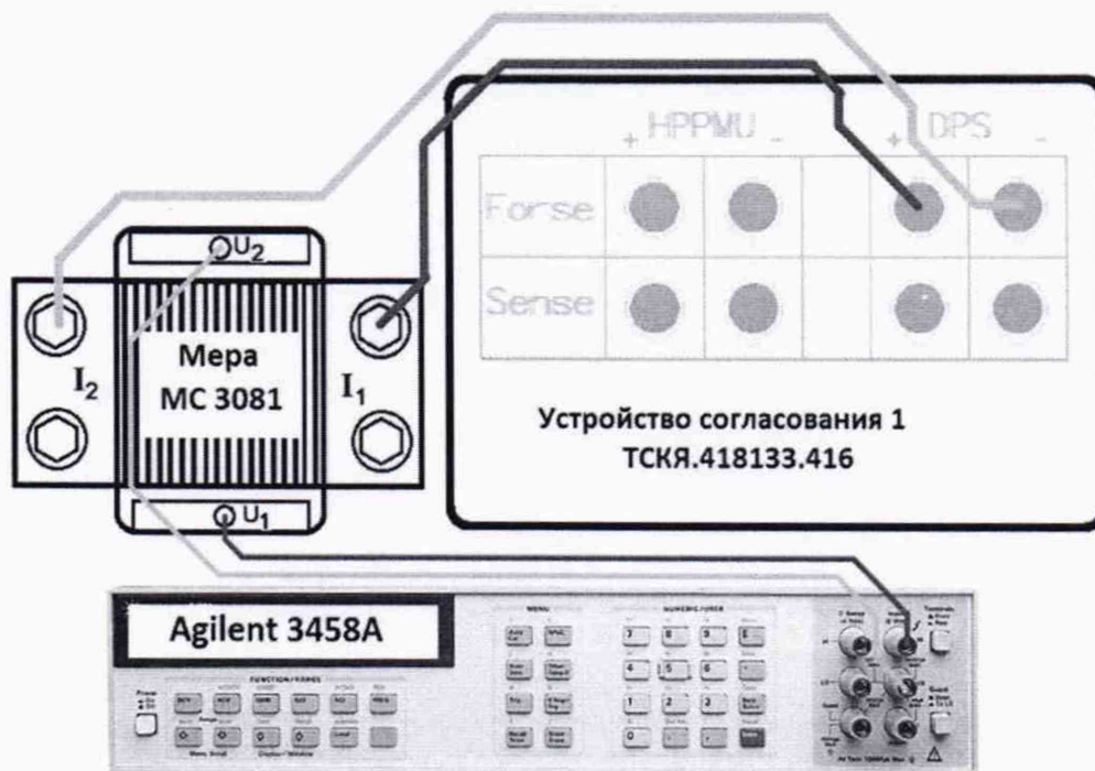
Рисунок 27 – Схема определения погрешности ограничения силы тока группой каналов источника питания DCS DPS128
