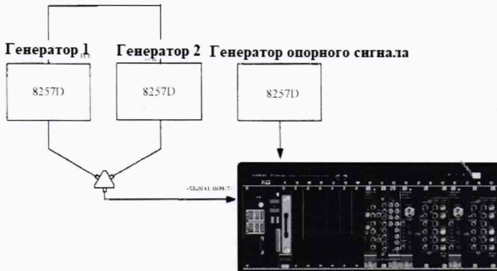
Рисунок 6 - Схема соединения при измерении фазового шума
