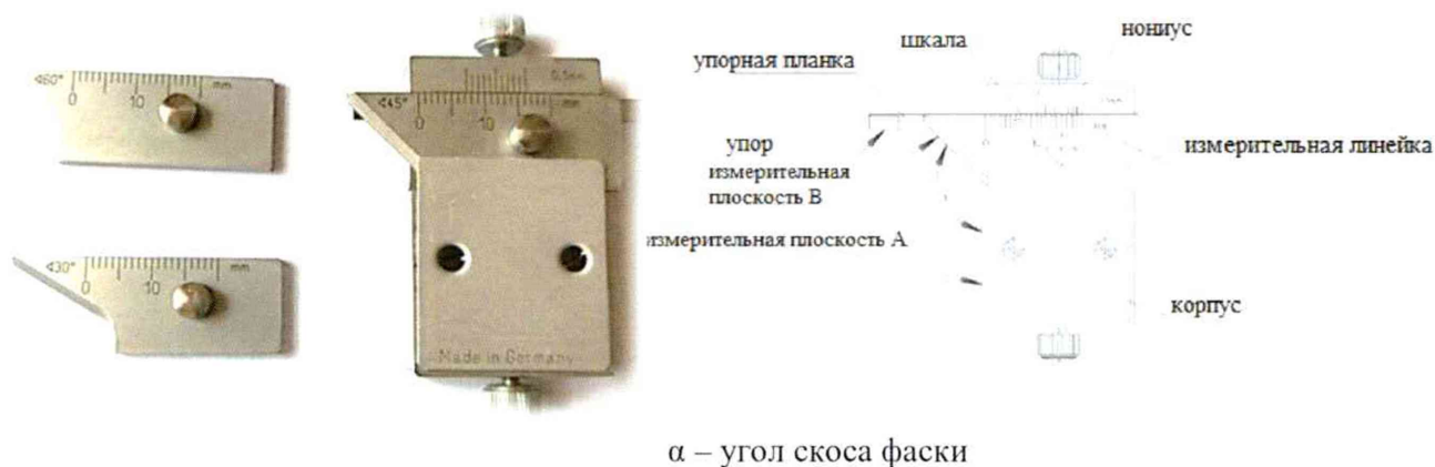
Рисунок 1 – Общий вид и конструкция шаблона для фасок Holec
