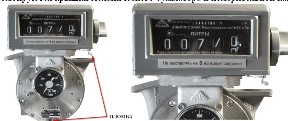
Рисунок 1 – Счетчик жидкости лопастной МКА 2290
