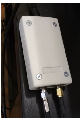
Рисунок 5 – Внешний вид устройства синхронизации СШП-передатчика и СШП-приёмника: общий вид (слева), вид со стороны разъёмов (справа)
