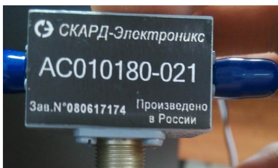
Рисунок 8 – Внешний вид малошумящего усилителя AC010180-021
