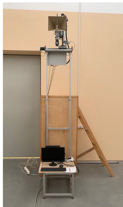
Рисунок 1 – Внешний вид комплекса: прецизионное ОПУ Радант 4К3300-062 (слева) и комплект средств технического оснащения для закрепления вспомогательных антенн (справа)
