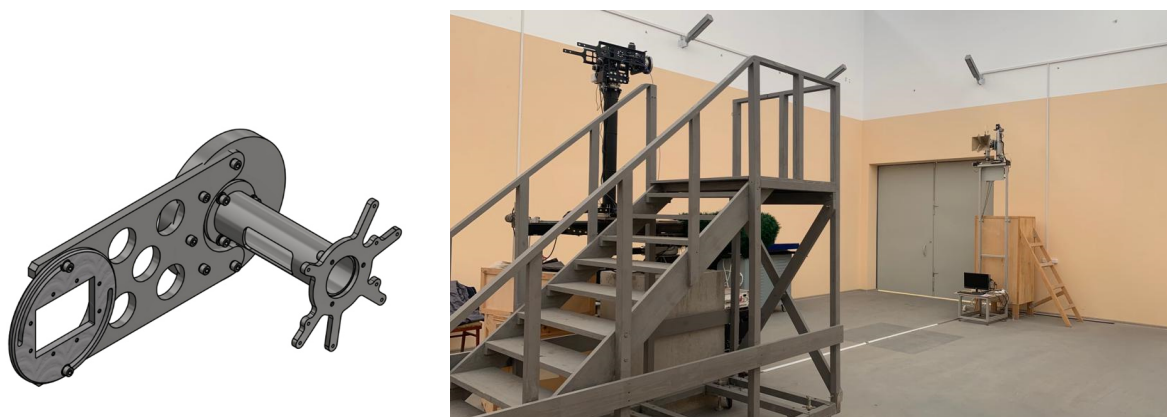
Рисунок 7 – Внешний вид комплекта средств технического оснащения для закрепления испытуемых антенн на ОПУ: кронштейн для закрепления антенн (слева), стремянка (справа)
