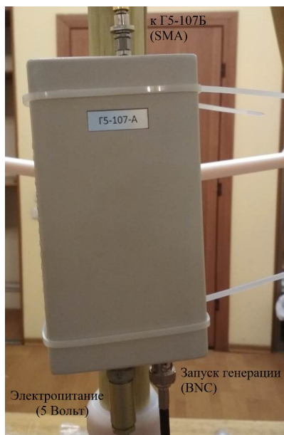
Рисунок 3 – Внешний вид СШП передающего устройства Г5-107: блок предварительного формирования импульсов Г5-107-А (слева), и блок формирования импульсов Г5-107-Б (справа)
