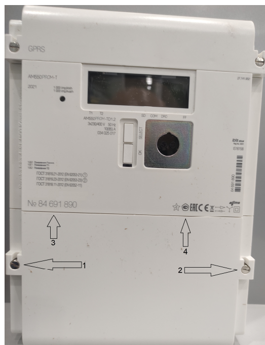
Рисунок 2 - Схема пломбировки от несанкционированного доступа (1), место нанесения знака поверки (2), место нанесения заводских номеров (3) и место нанесения знака утверждения типа (4) на счетчике AM550PROM-T
