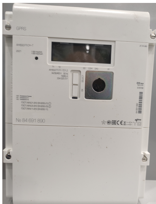
Рисунок 1 - Общий вид счетчиков электрической энергии трехфазных многофункциональных AM550PROM-T
