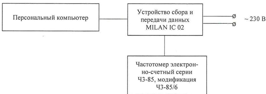
Рисунок 1 – Схема подключения
