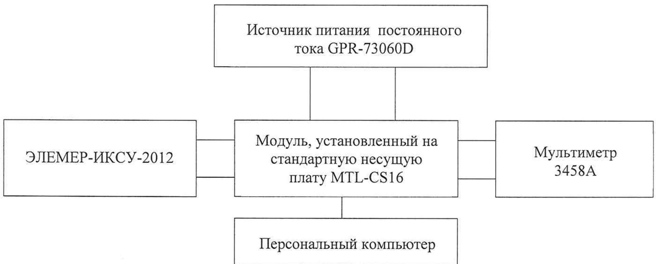
Рисунок 1– Схема подключений для поверки модуля в режиме аналогового ввода «АI»
