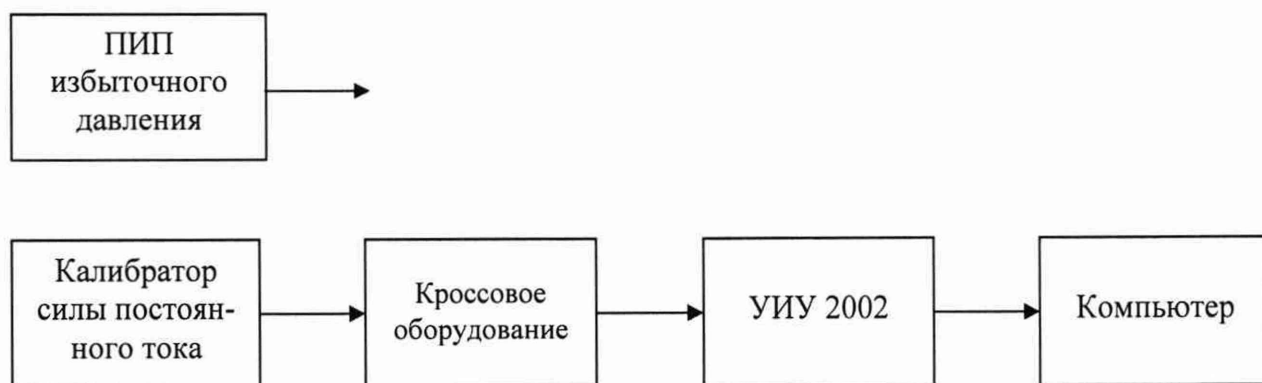
б) Схема определения метрологических характеристик поэлементным способом
