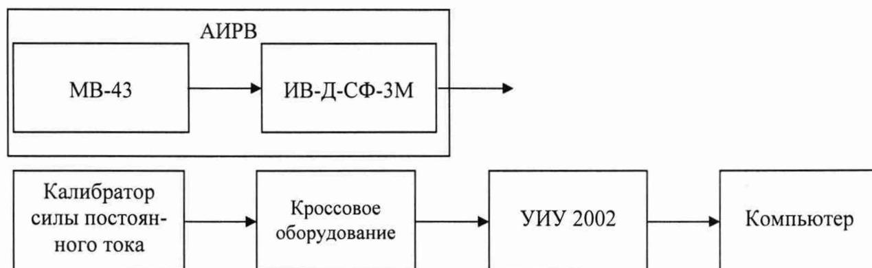
Рисунок 9 - Схема определения метрологических характеристик ИК виброскорости
