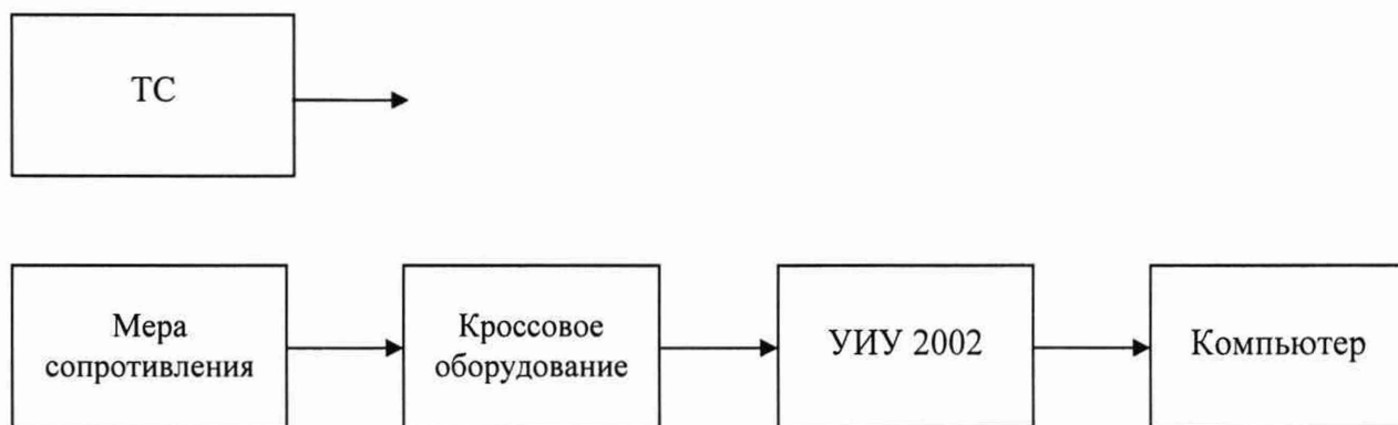
б) Схема определения метрологических характеристик поэлементным способом
