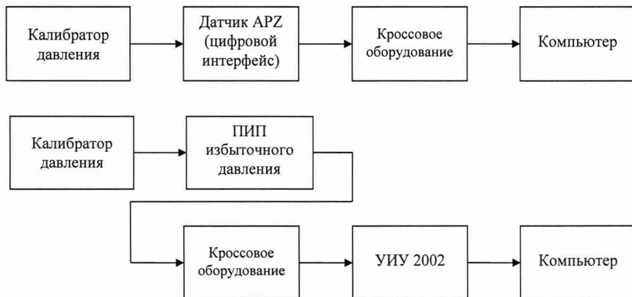
а) Схема определения метрологических характеристик комплектным способом
