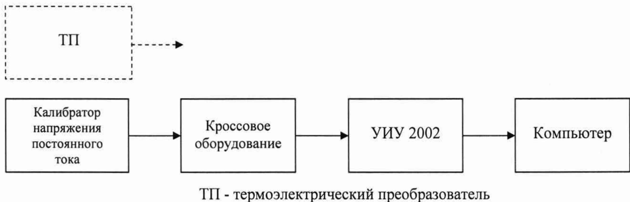
Рисунок 7 - Схема определения метрологических характеристик ИК напряжения постоянного тока, соответствующего значениям температуры, измеряемой термоэлектрическими преобразователями ХА и ХК по ГОСТ Р 8.585-2001
