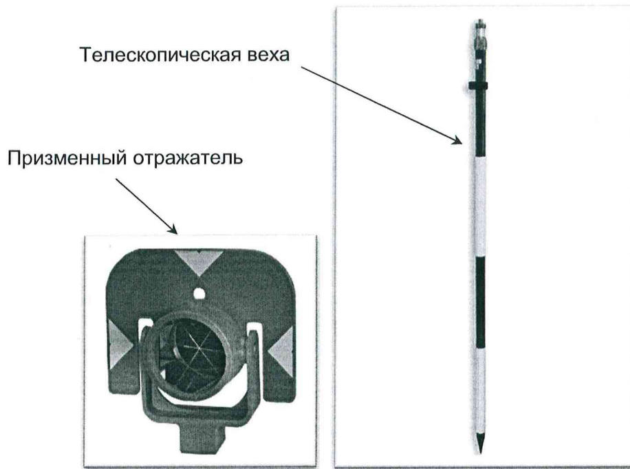
Рисунок А.1 – Веха телескопическая с призмным отражателем
