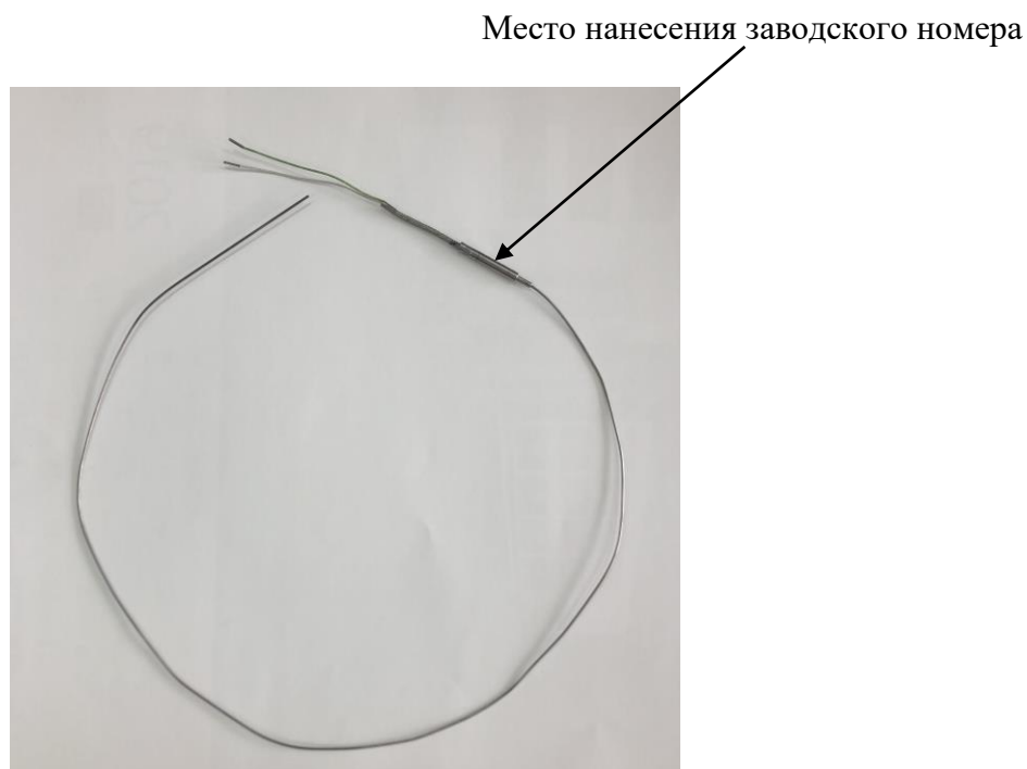
Рисунок 1 – Общий вид ТП с указанием места нанесения заводского номера
