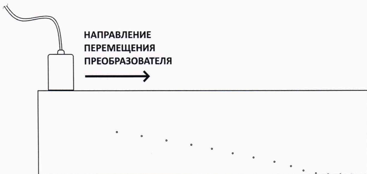
Рисунок 4 – Положение преобразователя на поверхности меры МД 2-0-1
