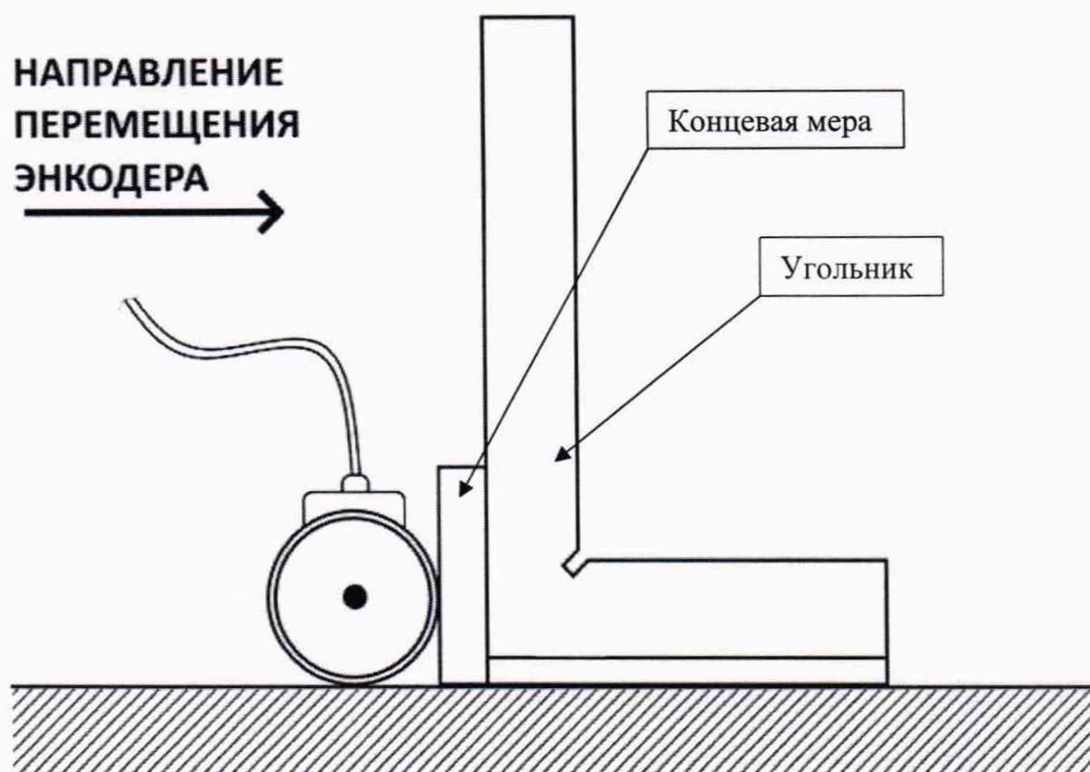
Рисунок 6 – Нулевая позиция энкодера
