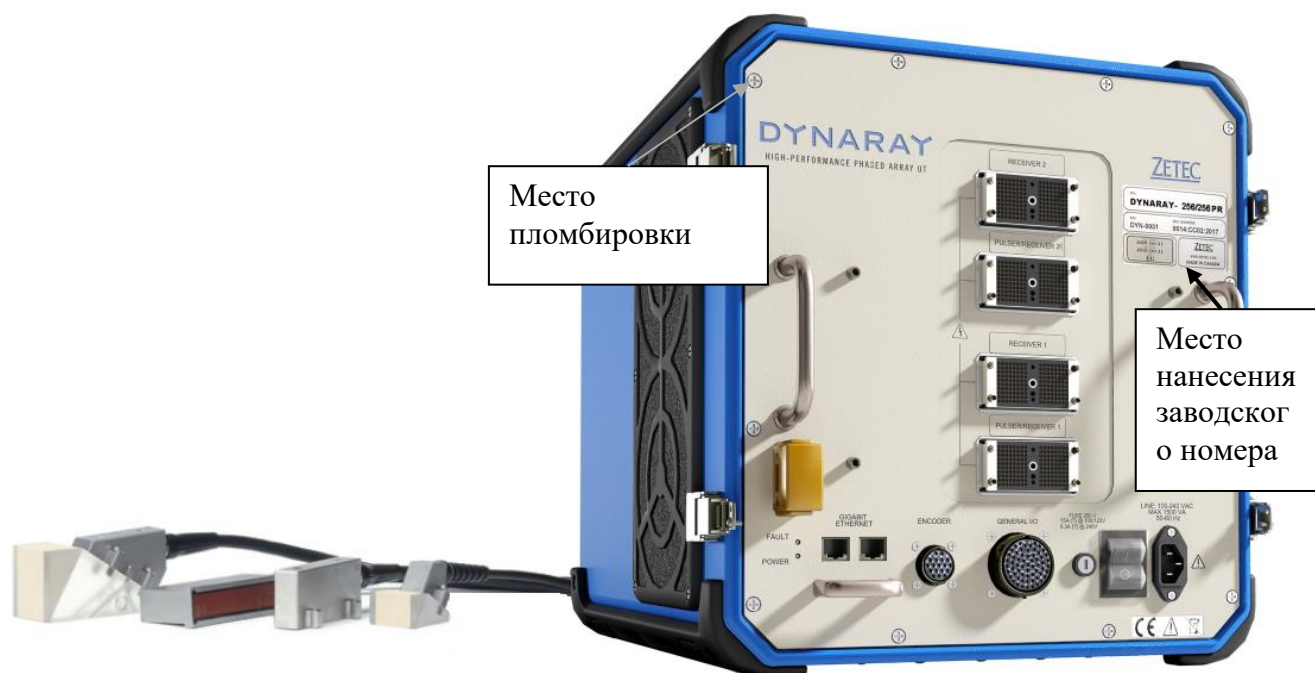
Рисунок 1 – Общий вид, схема пломбировки и обозначение места нанесения заводского номера дефектоскопов ультразвуковых DYNARAY
