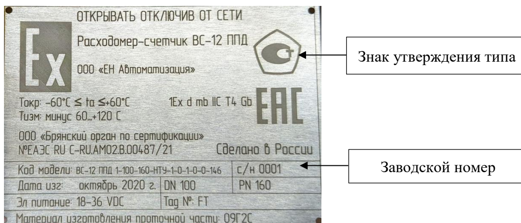
Рисунок 2 – Место нанесения заводского номера и знака утверждения типа
